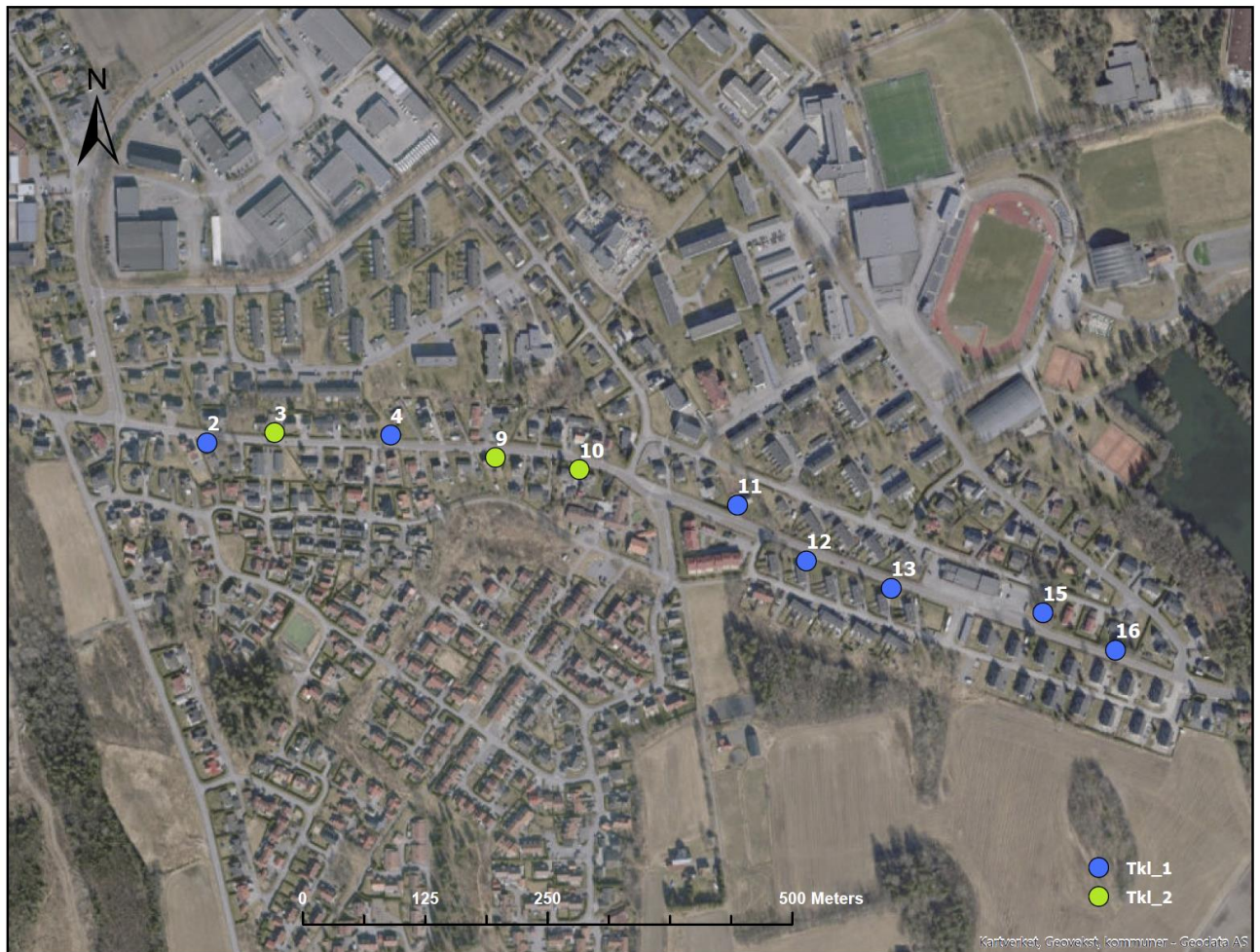
Figur 4.1 Tilstandsklassen til jordprøvene i hvert borehull langs Krokemoveien
