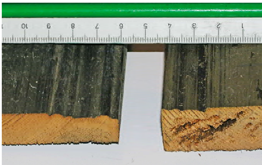
Profil på innvendig himling til venstre, og profil på utvendig kledning til høyre
