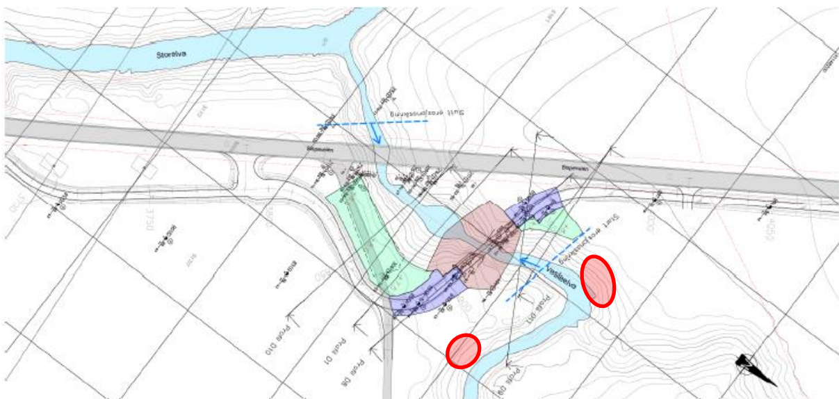
Figur 2. Situasjonsplan med hovedplanområdet mellom de to blå stripede linjer for anbefalte geotekniske tiltak. Grønt = senket terreng. Blått Lettfylling. Rødt = Utslakning av skrånninger. Det er også vurdert mindre erosjonssikringstiltak etter naturbaserte prinsipper (uten utgraving av elvekanten og f.eks. med bruk av nedpluggede erosjonsmatt) på to svinger i Vesleelva like ovenfor planområdet (røde sirkler). Kilde: Dagfin Skaar 2022.
