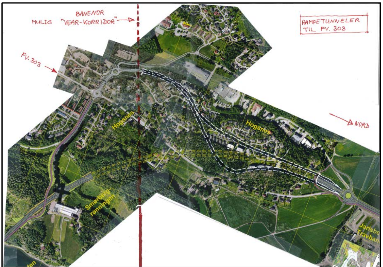
Figur 14: Rampetunneler for fv. 303 under Hogsnesåsen. De 2 parallelle tunnelene på ny fastlandsforbindelsen vises med gul stiplet strek og rampetunnelene til/fra fv. 303 på Vear med hvit stiplet strek. Jarlsberg Travbane ligger til høyre og Vear til venstre på skissen.
