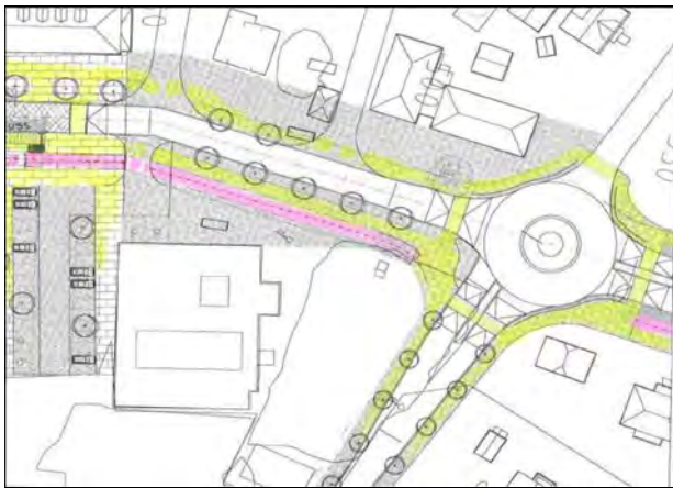
Kryssing av Teglverksveien, sykkel og fotgjengere blandet
