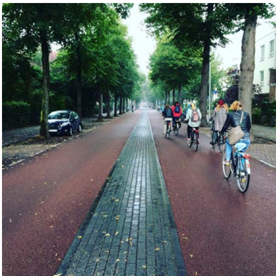
Figur 12 Eksempel på sykling i gata «med bilen som gjest». Løsningen foreslås i Vesfoldgaten. Foto: Lene Stenersen (fra Nederland).
