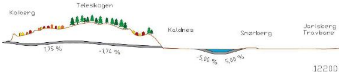
Figur 6: Lengdeprofil av veglinje 12200.
