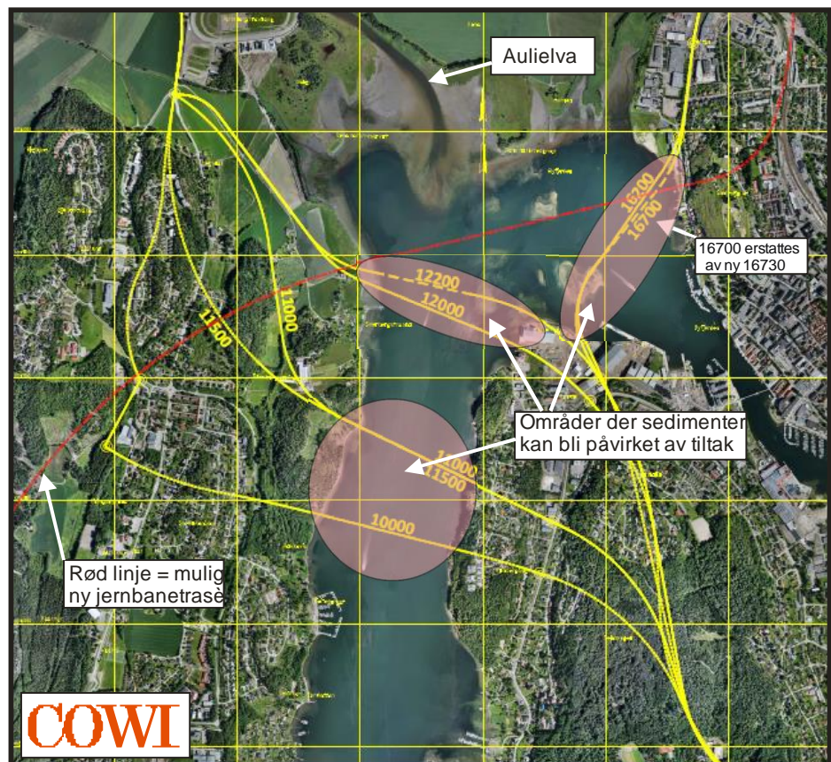
Figur 3.1: Oversikt over mulige tiltaksområder (rosa skravur), Aulielva og en mulig trasè for ny jernbane til Tønsberg sentrum.
